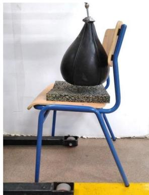
*Figura 17: Ensayo de durabilidad sobre el asiento según norma americana ANSI BIFMA X6.1.*
