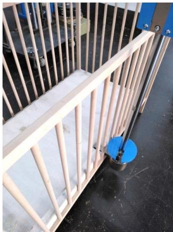
*Figura 8: Ensayo de impacto cíclico sobre el lateral según la norma americana ASTM 1169-13.*
