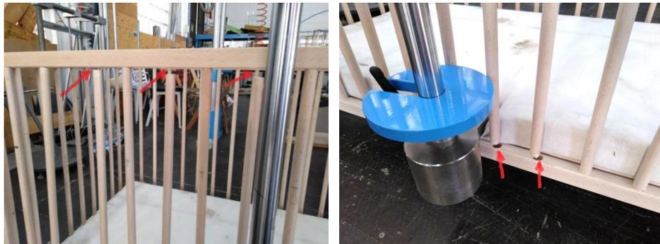
*Figura 22: Separación de los barrotes (Flechas rojas) en la Cuna UE tras realizar el ensayo de resistencia de los laterales según la norma americana ASTM 1169-13.*
