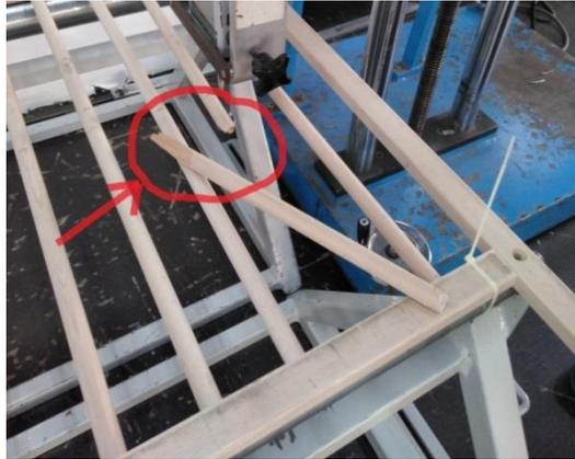
*Figura 23: Rotura del segundo barrote ensayado durante la realización del ensayo de resistencia del cabecero según la norma ASTM 1169-13.*
