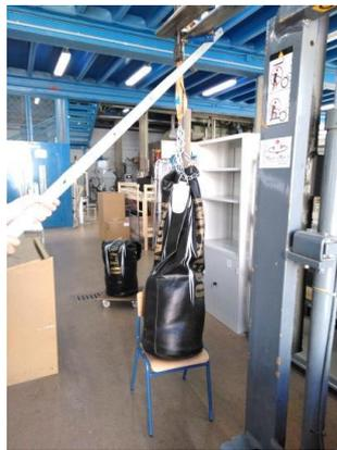
*Figura 16: Ensayo de impacto de 102 Kg sobre el asiento según norma americana ANSI BIFMA X6.1.*
