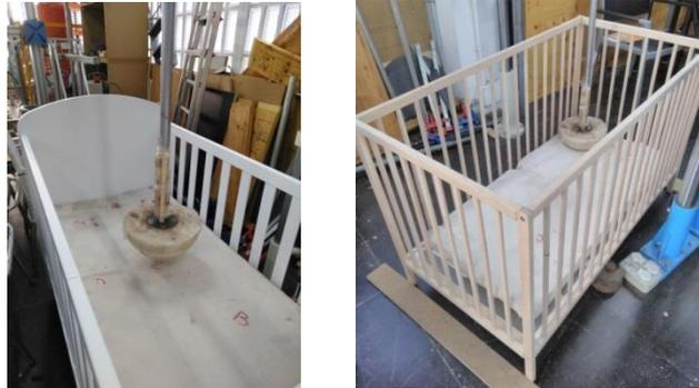
Figura 3: Ensayo de resistencia del somier en la Cuna ES y la Cuna UE.
