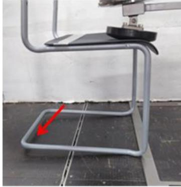
*Figura 20: Vuelco delantero para asientos no giratorios*
