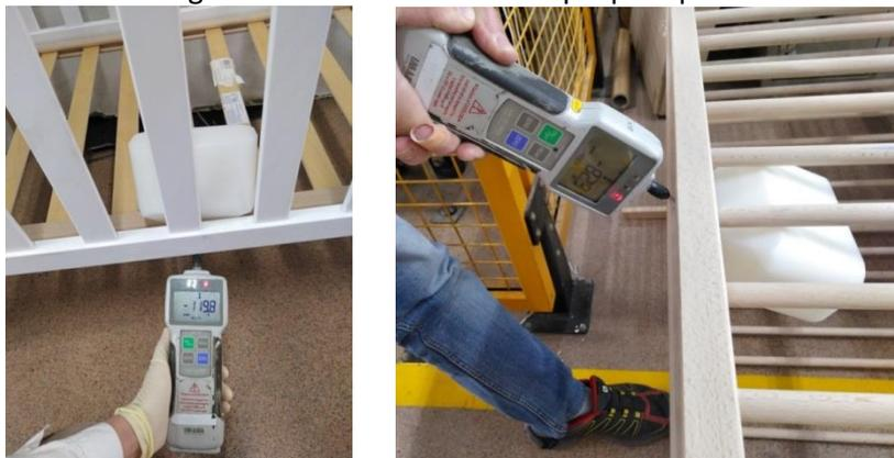
*Figura 7: Ensayo de inserción del bloque de cuña con aplicación de fuerza según la norma americana ASTM 1169-13.*
