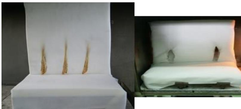
*Figura 18: Inflamabilidad con fuentes 1 y 2 con resultado favorable en muestras de espuma de poliuretano y guata PET 100%.*
