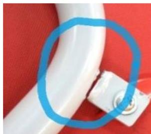
*Figura 24: Rotura de la soldadura de la pletina de fijación de la estructura a la carcasa del asiento de la “Silla Roja” durante el ensayo de caída según la norma europea UNE EN 1729.*
