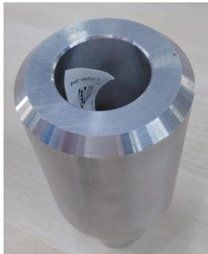
*Figura 21: Etiqueta de la Cuna UE que presenta riesgo de asfixia, ya que entra dentro del cilindro normalizado.*
