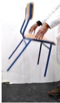
*Figura 12: Ensayo de caída según norma europea UNE EN 1729.*
