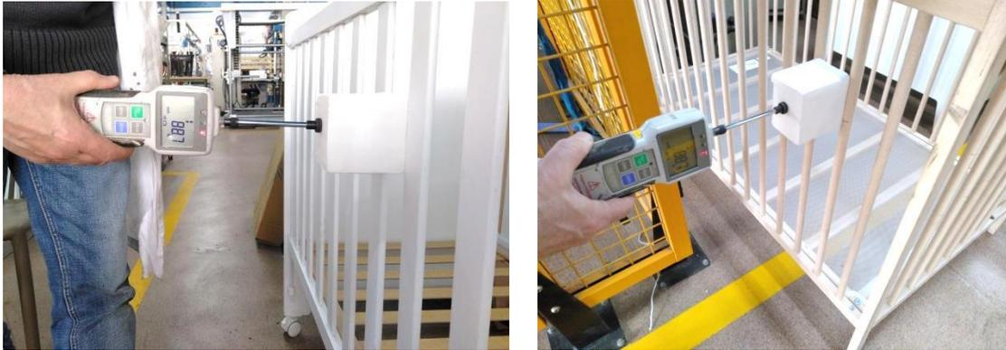
*Figura 6: Análisis de la distancia entre componentes con aplicación de fuerza, de la Cuna ES y la Cuna UE según la norma ASTM 1169-13.*
