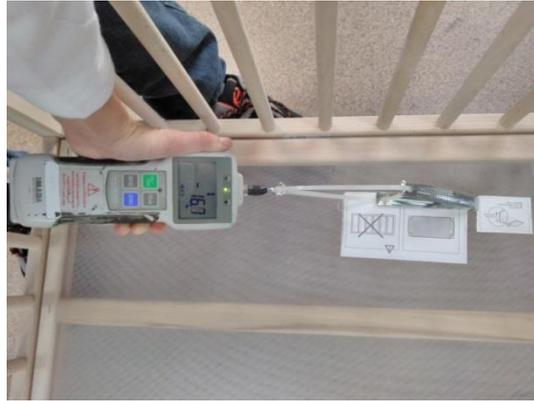
Figura 5: Ensayo de arranque con dinamómetro de las etiquetas cosidas en la Cuna UE.
