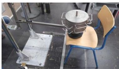
Figura 11: Ensayo de estabilidad delantera según UNE EN 1729 en la “Silla Madera” en estudio.
