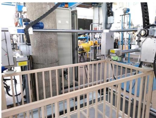
*Figura 9: Ensayo de resistencia de la estructura en vertical según la norma americana ASTM F1169-13.*
