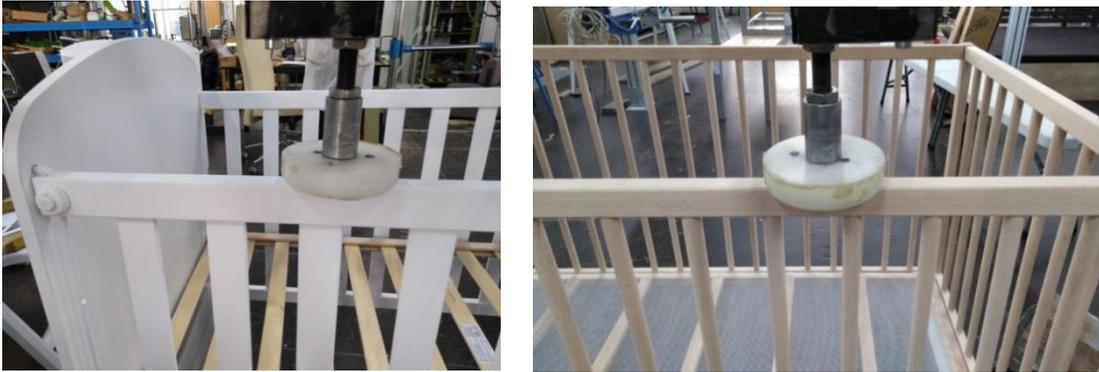
Figura 4: Ensayo de carga estática vertical según la norma europea EN 716:2017
