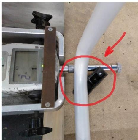
*Figura 25: Rotura de la cuña antivuelco en la “Silla Azul” tras la realización del ensayo de resistencia lateral de las patas según la norma americana ANSI BIFMA X6.1.*
