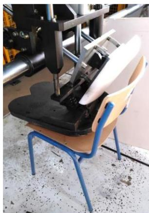
*Figura 13: Ensayo de durabilidad del asiento y el respaldo según norma europea UNE EN 1729.*
