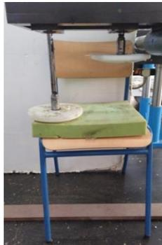
*Figura 14: Ensayo de durabilidad del borde delantero del asiento según norma europea UNE EN 1729.*
